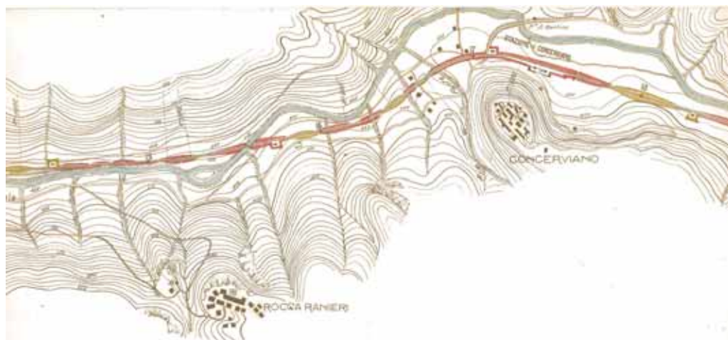
Fig. 31 - Planimetria del tratto della ferrovia Rieti – Avezzano lungo il fiume Salto, tra Concerviano e Rocca Ranieri. Lungo il tracciato delle ferrovie sono evidenziati i tratti in galleria (tratteggiati) e i ponti sul Salto (Progetto Cidonio S.p.A., 1922)
