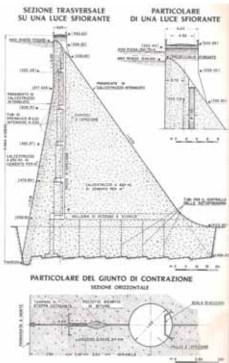
Particolari delle dighe a ritenuta sul Salto (a sinistra) e sul Turano (ANIDEL, 6, 1952)
